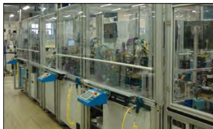
由 C&K 设计和制造的高速开关组装机
