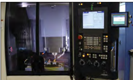
用于建立工具和机器的高速精密铣床
